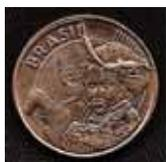
**Reverso Inclinado** – é gerado quando um dos cunhos não foi fixado exatamente no mesmo eixo do outro, podendo ser reverso horizontal, quando a diferença é de 90 graus ou reverso invertido, quando a diferença é de 180 graus.
